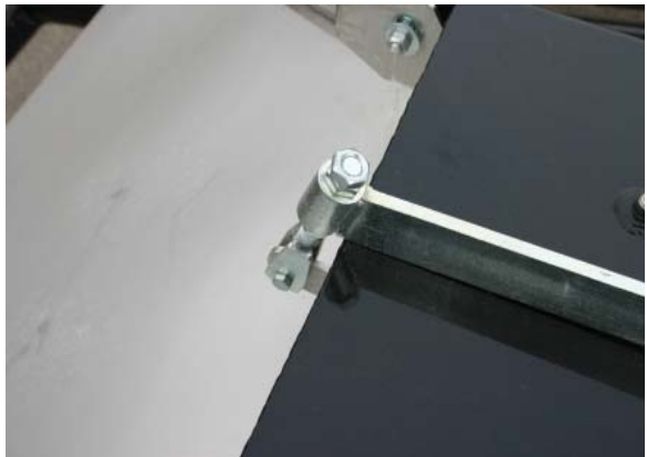
Jam nuts on hold-down bar
