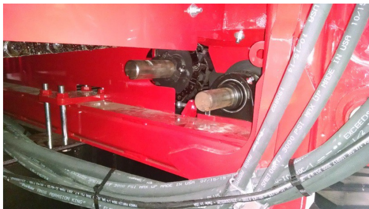
Рис. 9-2: Приводы подающего вала и центрального нижнего транспортера
