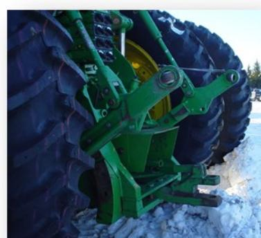
Рисунок 4-3: Полностью поднятый трехохордный hitch
