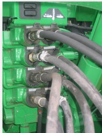
Рисунок 5-1: Присоединение гидравлических линий
