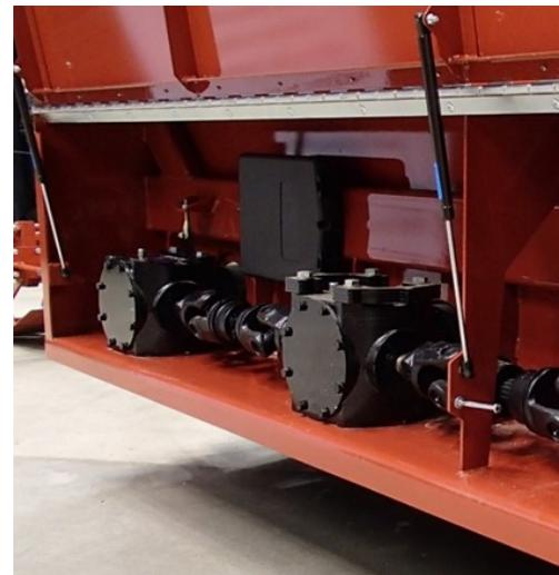
Рисунок 7-5: Коробка передач 3-я регулировка барабана
