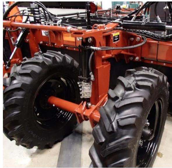
Рисунок 7-2: Регулировка высоты заднего стойки
