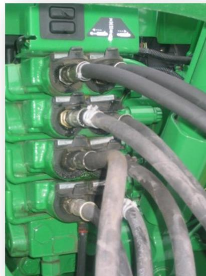
Рисунок 5-1: Присоединение гидравлических линий
