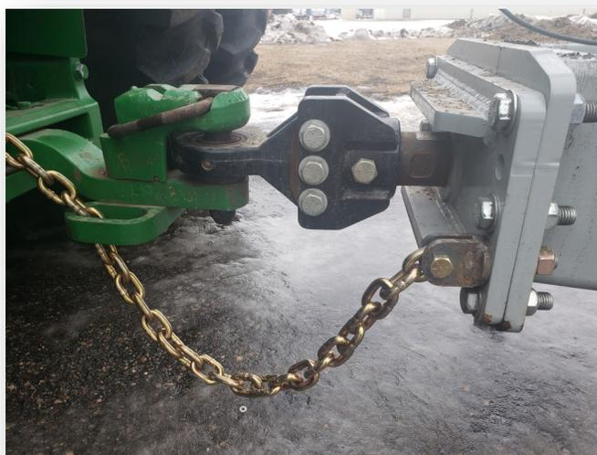
Рисунок 5-2: Прикрепление корзины к трактору Drawbar
