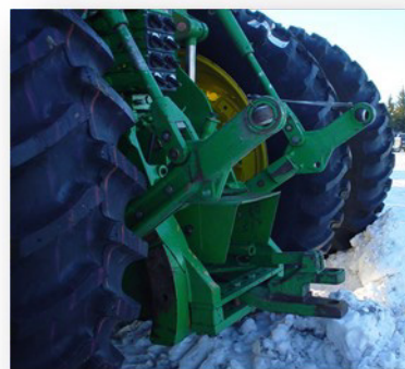
4-3-сурет: Үш нүктелі тіркеменің толық көтерілген күйі
