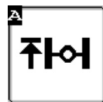
13-15-сурет: Артқы осьті ең жоғарғы деңгейге көтеру үшін арналған жұмсақ перне
