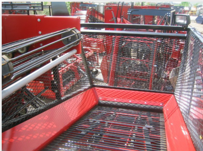
Рисунок 9-6: Очистка свекловичного бункера
