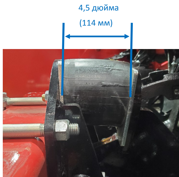
Рисунок 7-7: Натяжение амортизатора камней
