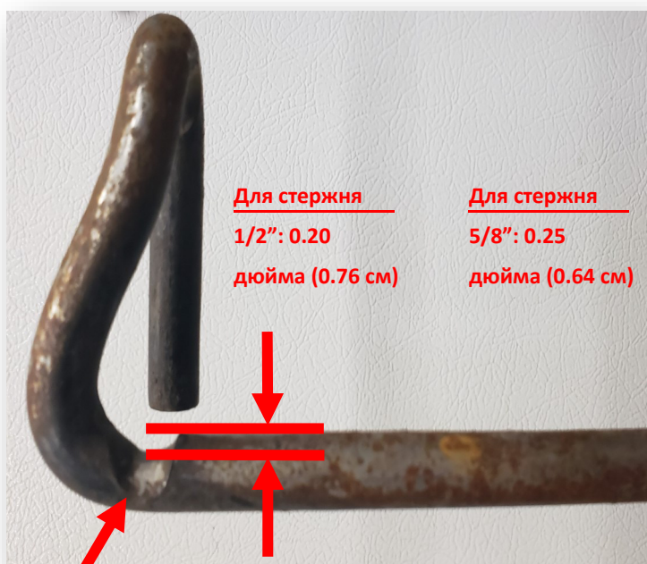
Рисунок 11-8: Износ цепи крючкового стержня
