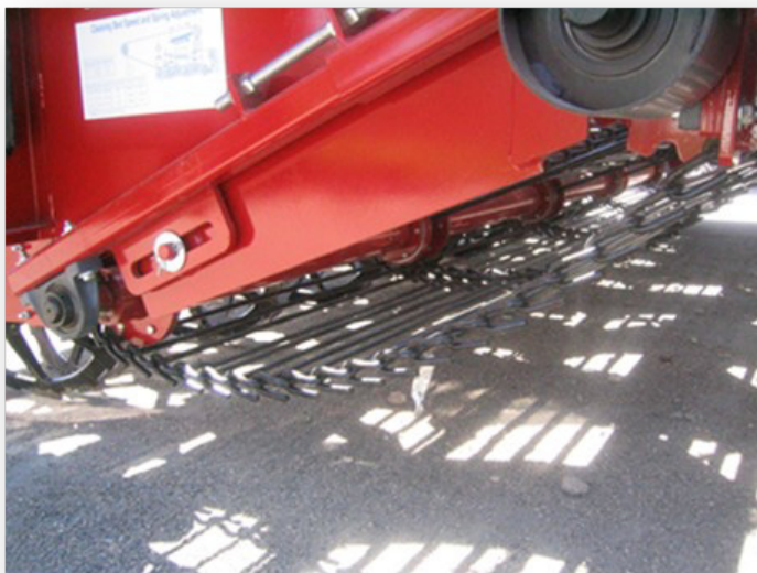
Рисунок 9-4: Очистка валов транспортёра
