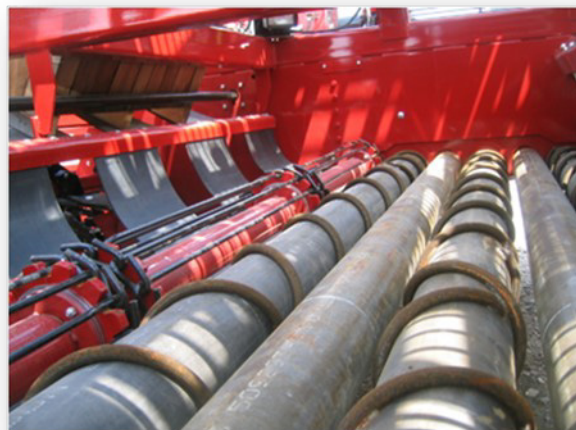
Рисунок 9-3: Очистка захватных вальцов
