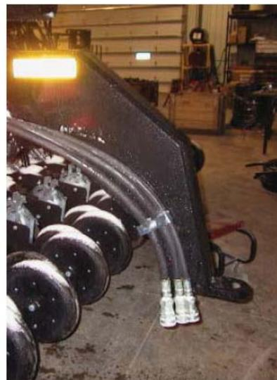
Два плоских кронштейна крепятся в нижней части задней сцепки для поддержки шлангов. Закрепите кронштейны на сцепке п-образным болтом и зафиксируйте на них шланги хомутами и болтами  $\frac{3}{8}$  дюйма. Закрепите шланги на задней сцепке с помощью удерживающего хомута и болта  $\frac{3}{8}$  дюйма.
