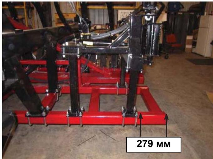
Установите прямую опору внутри продольного компонента рамы. Закрепите п-образными болтами 5/8 дюйма, но не затягивайте.
