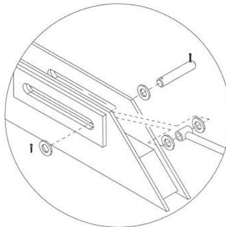
ПРИМЕЧАНИЕ: МЕЖДУ ГИДРОЦИЛИНДРОМ И ОПОРОЙ НА ОСНОВНОЙ РАМЕ РАСПОЛАГАЕТСЯ 2 ½ -ФУТОВЫЙ (762 ММ) УДЛИНИТЕЛЬ. ЗАФИКСИРУЙТЕ П-ОБРАЗНЫМИ БОЛТАМИ.
