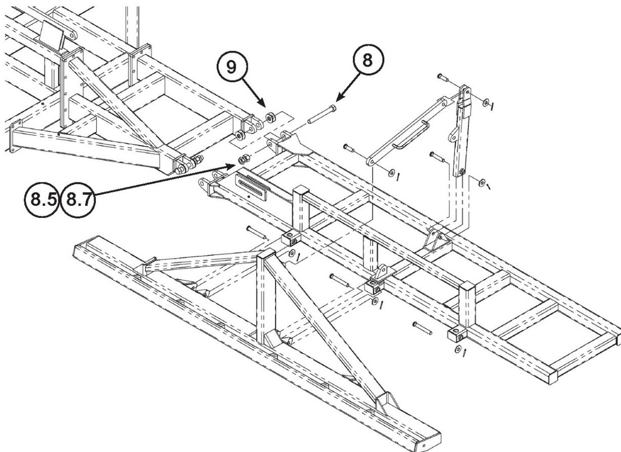
Закрепите рамы крыльев на основной раме с помощью болтов  $1\frac{1}{4}$  x 10 дюймов (поз. 8). Каждый болт затягивается одной обычной гайкой и одной более узкой контргайкой (поз. 8.5 и 8.7). Болты должны быть затянуты только так, чтобы не было поперечного люфта. Не затягивайте до упора с проушинами. Прочно затяните контргайку до упора с обычной гайкой.
