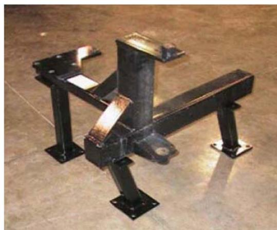
Установите штанги маркеров в главный держатель с помощью 1 ¼-дюймовых штифтов и закрепите болтом 3/8 дюйма и контргайкой.
