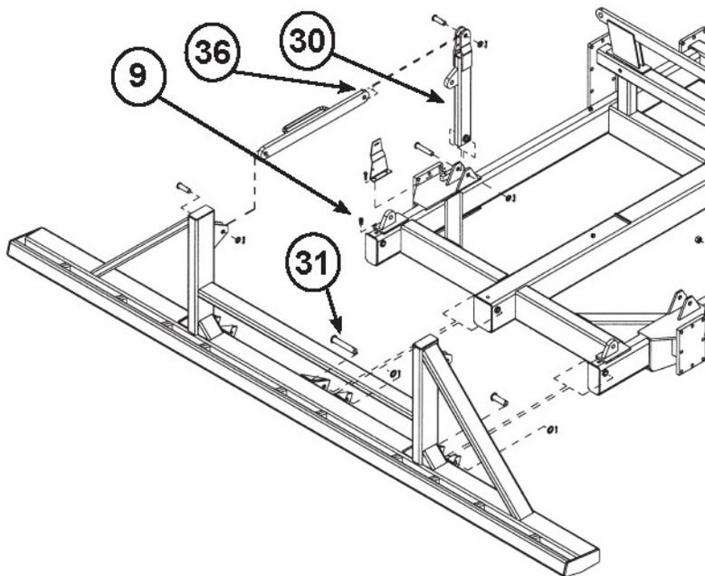
Регулируемые планки используются только на основной раме. Имейте в виду, что верхняя соединительная планка рамы крыла не регулируется (см. предыдущую страницу). Расстояние между центрами штифтов соединительных планок должно составлять 32 дюйма (813 мм).
