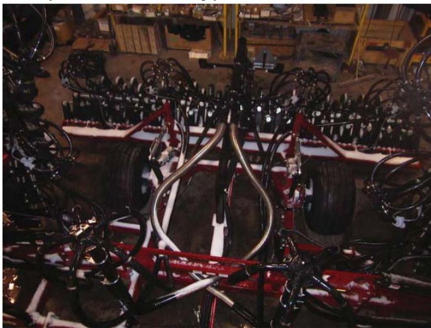
Стойки коллекторов первичного контура должны быть установлены почти на одном уровне, с небольшой разницей, которая позволит расположить 4-дюймовые шланги внахлест.
