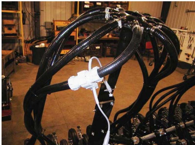
Два кабеля отходят от блока управления потоком на кронштейне крепления блоков. На концах кабелей со штекерами имеются стрелки. Штекер со стрелкой, направленной наружу, подключается к первому датчику на левой стороне сеялки. Если требуется, используйте удлинительные кабели. См. соединения кабелей на схеме внизу.
