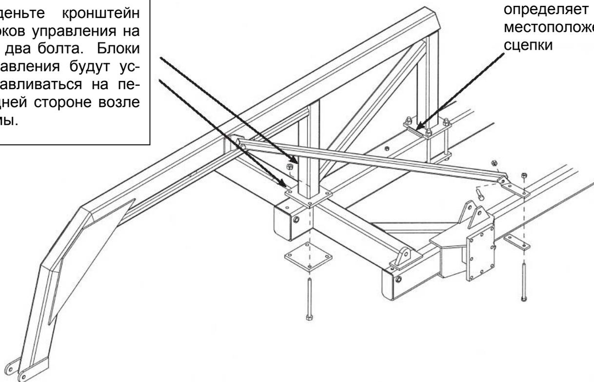
Наденьте кронштейн блоков управления на 2 болта крепления сцепки, как показано справа.
