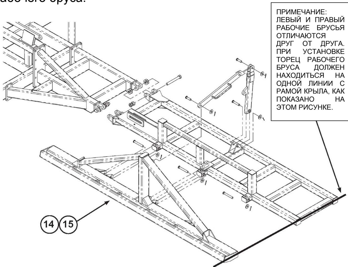
При установке бруса с правильной стороны торец рабочего бруса будет расположен на одной линии с торцом рамы крыла.
