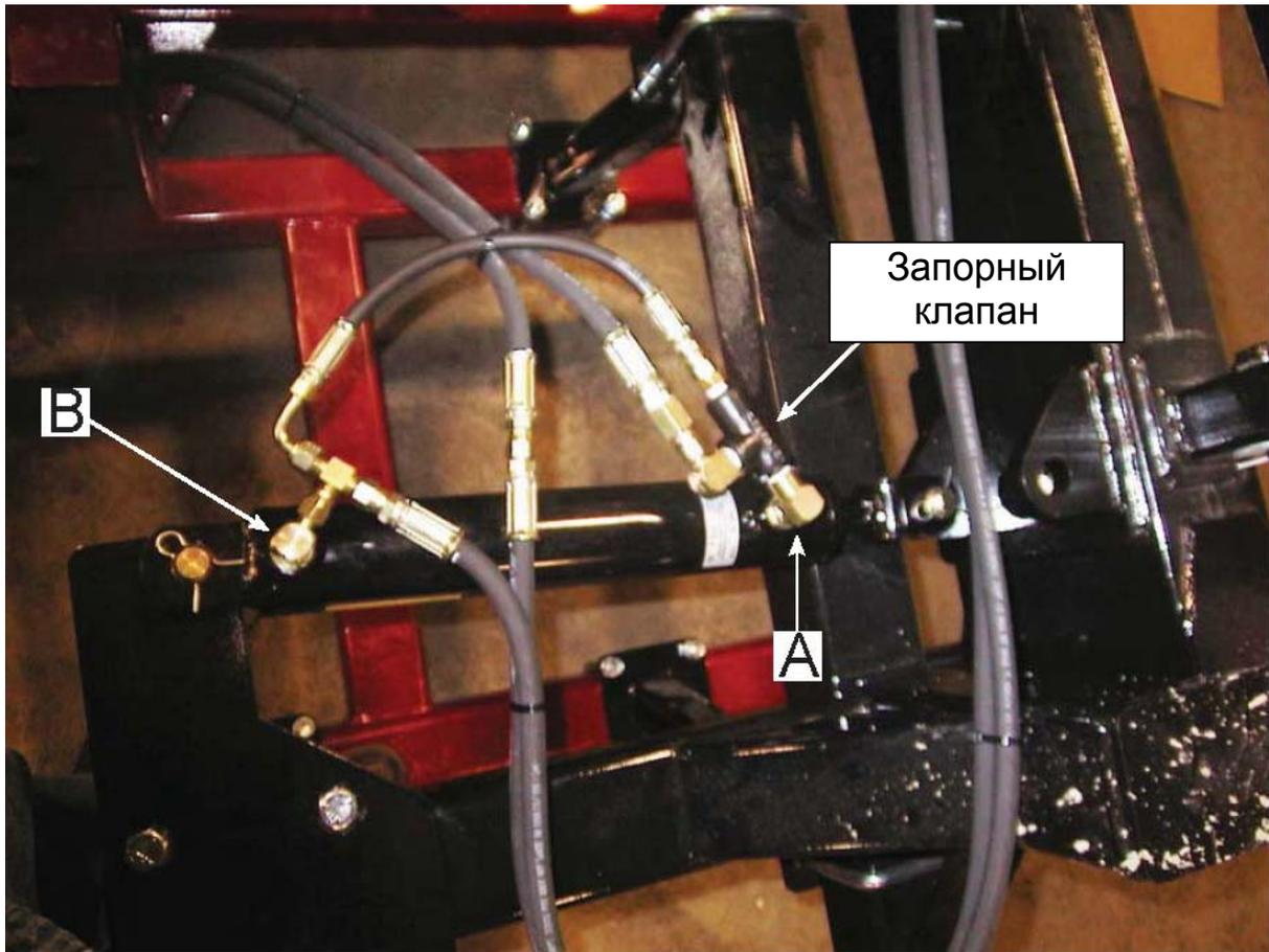
Шланги к гидроцилиндру поддерживаются штангой маркера (поворотный гидроцилиндр).
