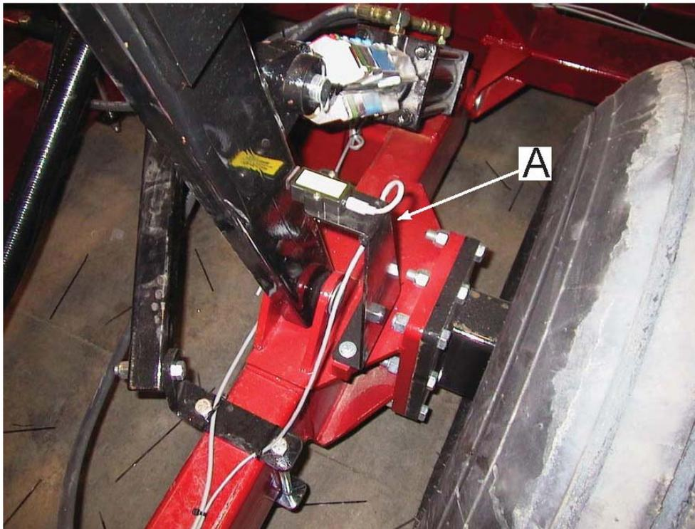
Рабочий выключатель должен быть расположен на расстоянии около 1/8 дюйма (3,2 мм) от электромагнита. Во время работы выключатель действует в обратном направлении, включая дозаторы семян в верхнем положении и выключая их в нижнем положении (полевая работа). Действие выключателя можно изменить путем настройки блока управления (см. инструкцию к блоку управления).
