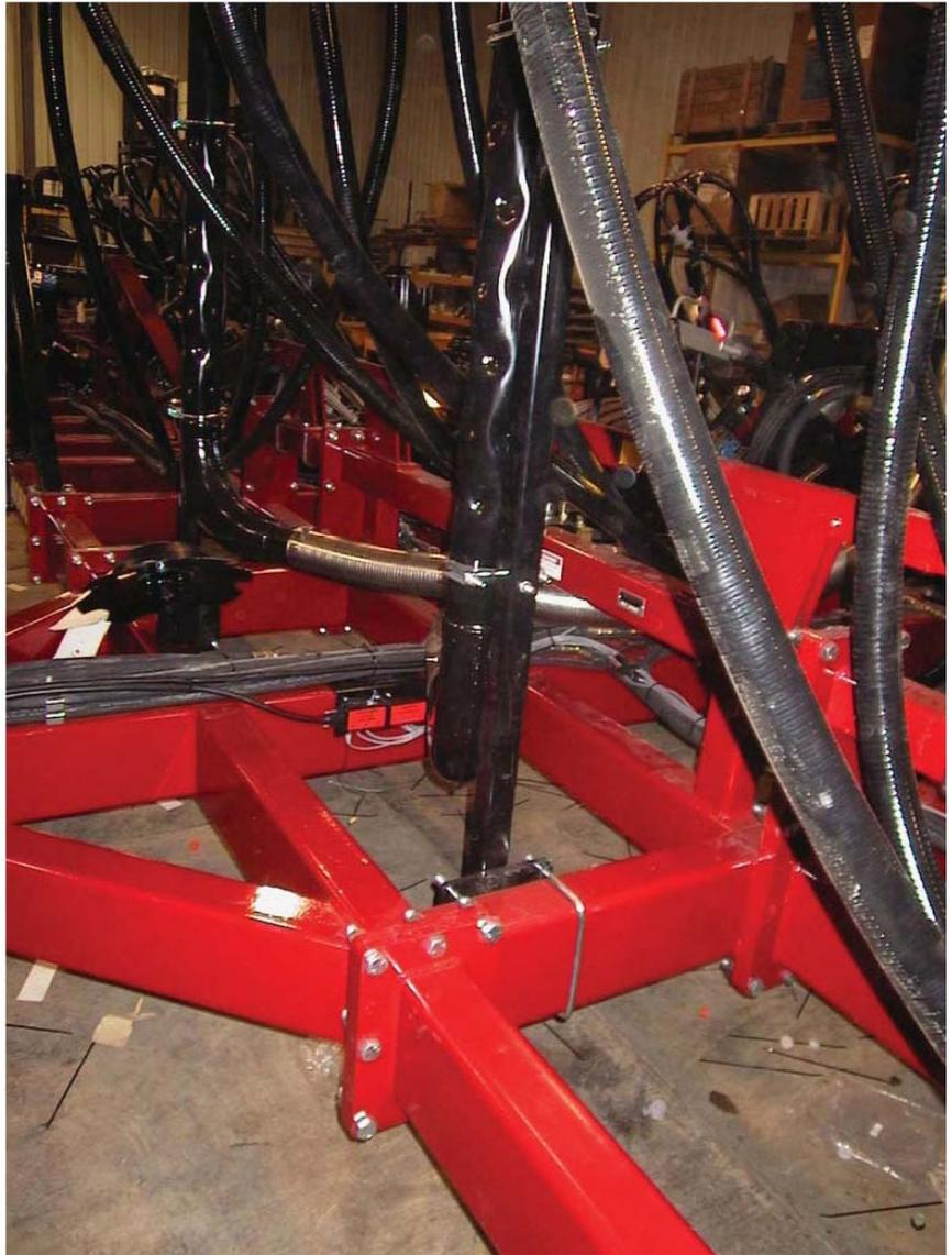
ниже верхней поперечины рамы. Сместите коллекторы на 2 дюйма (5 см) по высоте, чтобы облегчить подсоединение 4-дюймовых гибких шлангов.
