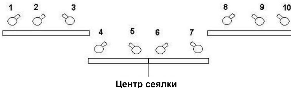
**Коллектор 1 – Установите между высевальными секциями 5 и 6 с левой стороны сеялки. Выпускное отверстие должно быть направлено в соответствии с рисунком.**
