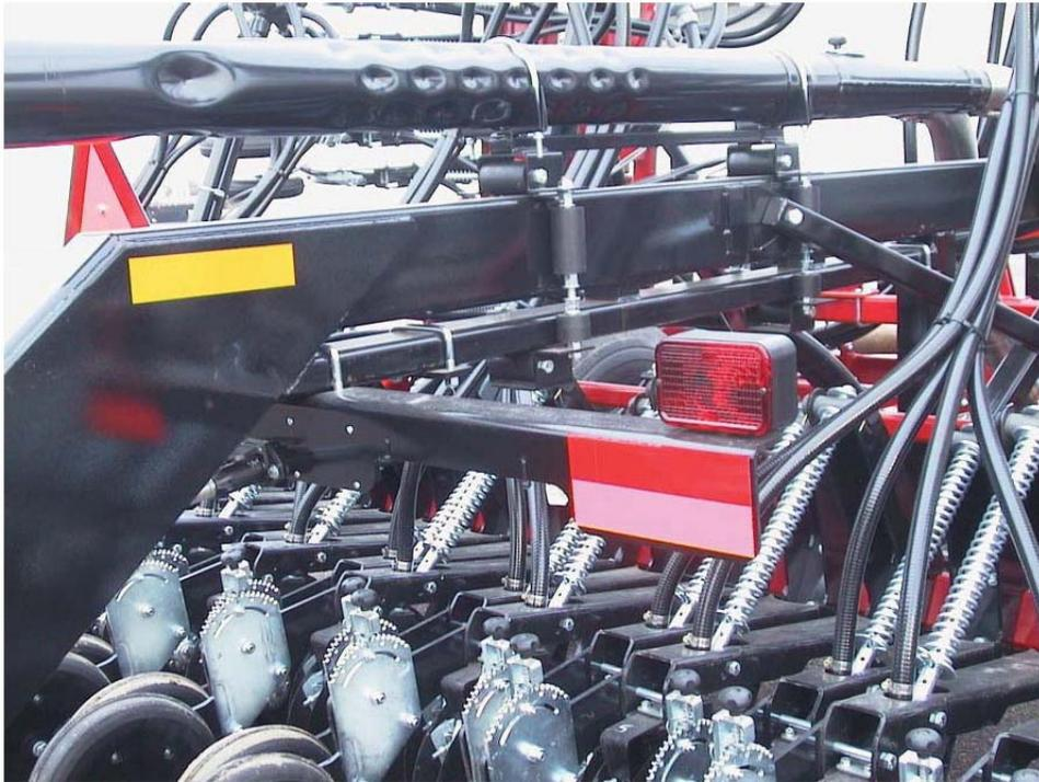
Кронштейн закрепляется на задней сцепке с помощью п-образного болта. Обратите внимание на расположение светоиндикаторов и табличек.
