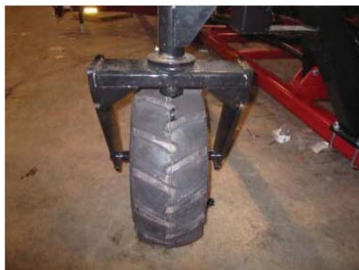
ПРИМЕЧАНИЕ: ГАЙКИ ОСИ ЗАТЯНИТЕ ТАК, ЧТОБЫ ПРИ ПОВОРОТЕ КОЛЕСА ЧУВСТВОВАЛОСЬ ЛИШЬ НЕБОЛЬШОЕ СОПРОТИВЛЕНИЕ. СЛИШКОМ СИЛЬНАЯ ЗАТЯЖКА ГАЕК ПРИВЕДЕТ К ПОВРЕЖДЕНИЮ ПОДШИПНИКОВ.
