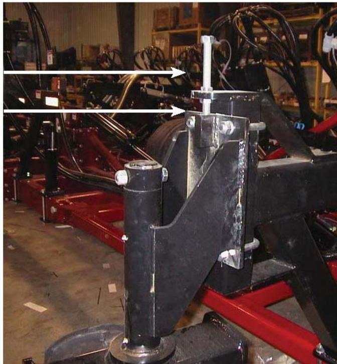
Нижняя сторона болта должна располагаться на 1 ½ дюйма (38 мм) от нижней стороны крепежной пластины. Зафиксируйте собранную самоориентирующуюся опору с помощью подобного болта (поз. 3) и ¾-дюймовых контргаек.
